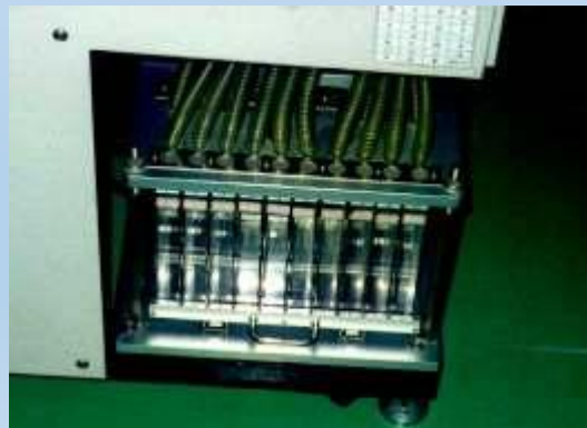
Step3: 測試後，材料進入分BIN盒
