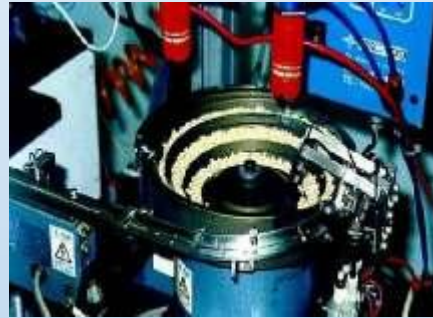
Step1: 將材料放於 振動盤
